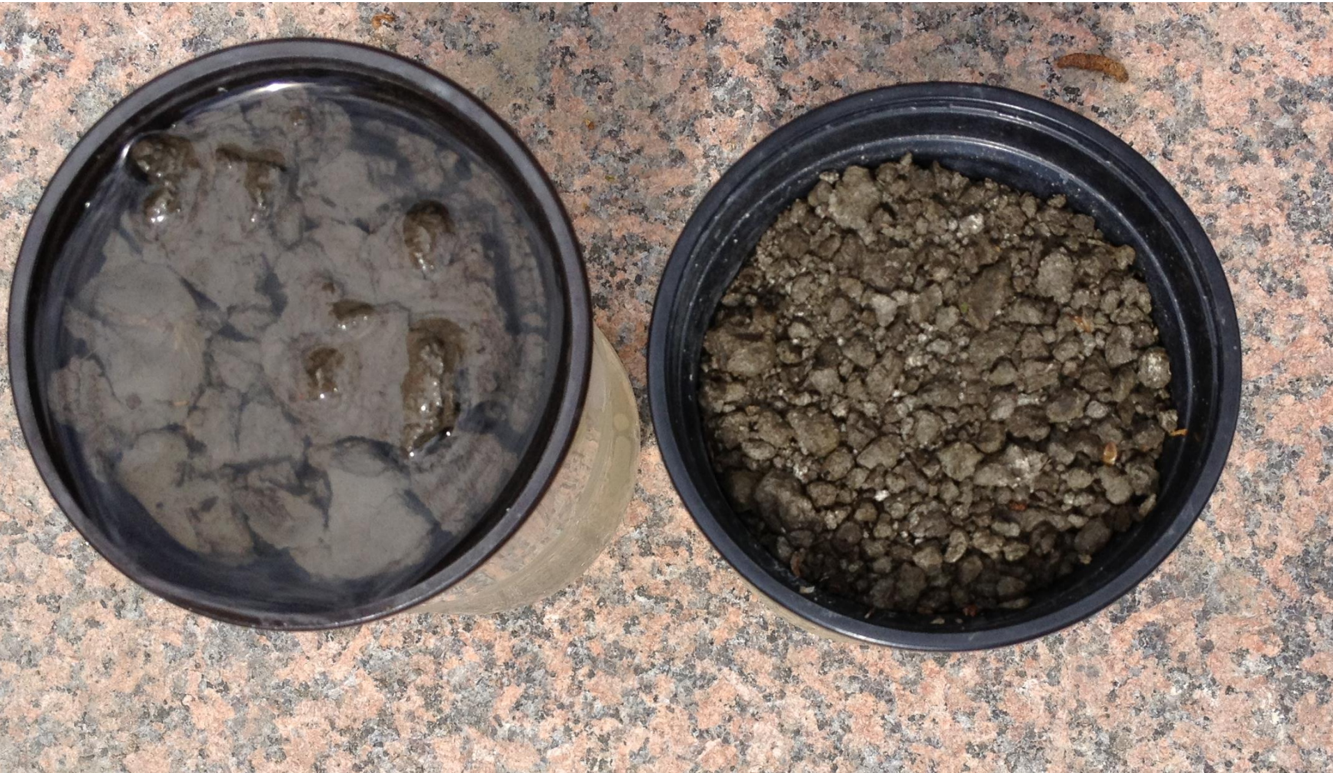
Strukturkalkad lera och obehandlad lera efter 115 mm regn
