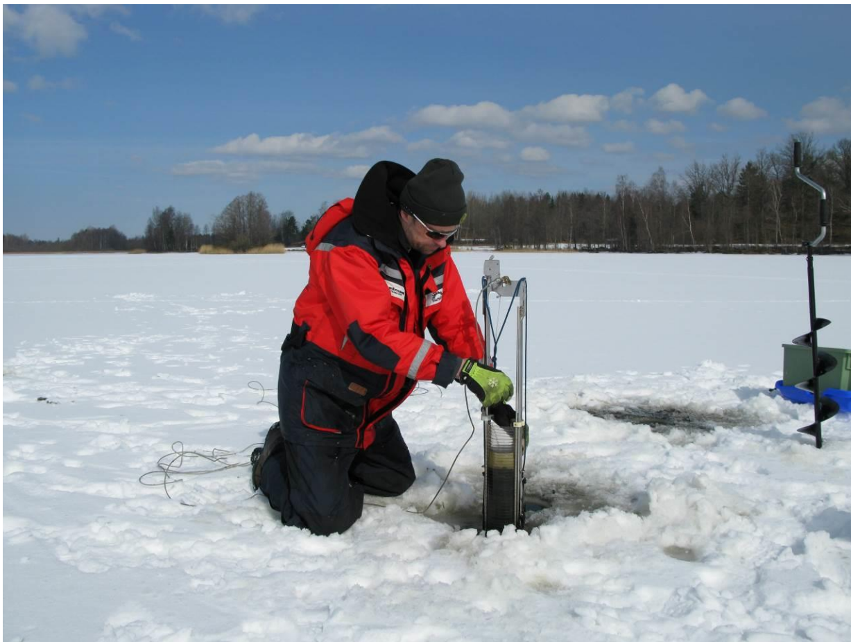
Figur 5. Sedimentprovtagning sker vart 6:e år inom SRK Emån (se tabell 2) och kan göras både från is och båt. Metodiken inom SRK Emån innebär att man tar flera prover inom den centrala djuphålan och tar vara på de översta 2 cm (ytsediment) i varje prov. Dessa samlas sedan i ett kärl och representerar ett s.k. samlingsprov som skickas in till laboratorium för analys enligt kontrollprogrammet
