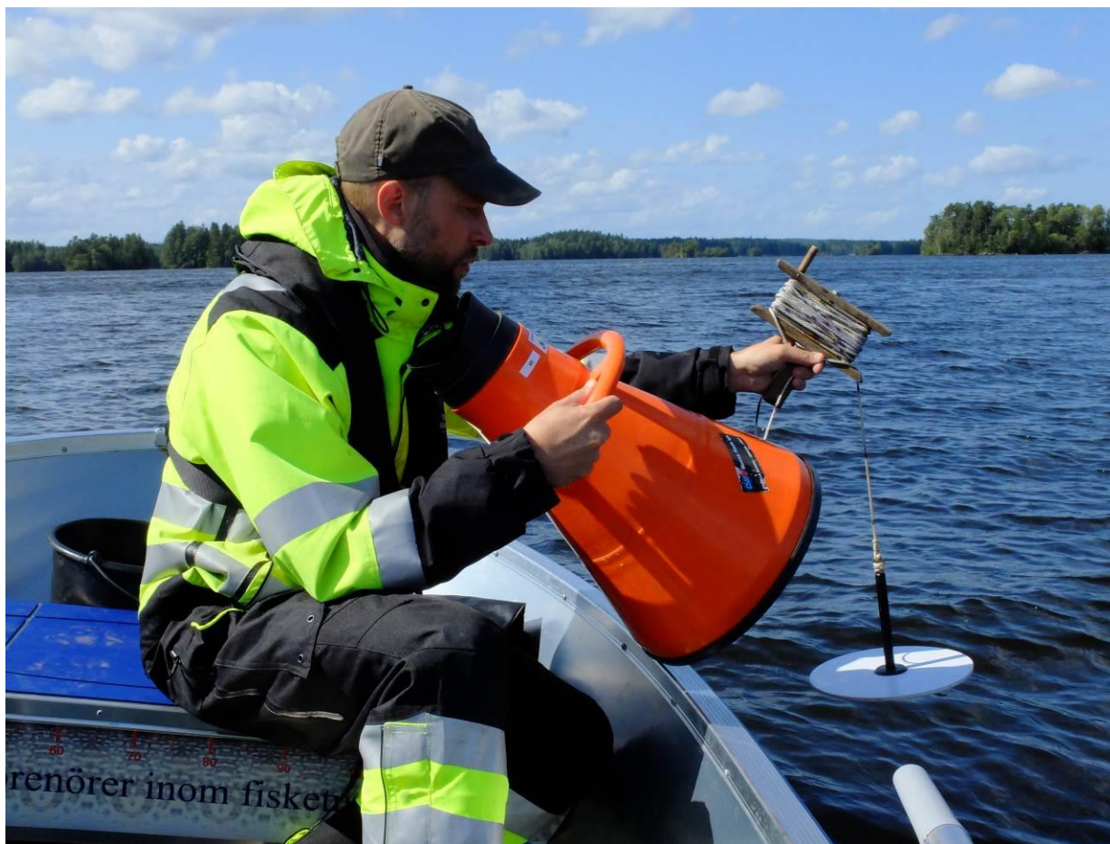
Figur 2. Att mäta siktdjup är en gammal metod för att bedöma ljusförhållanden i sjöar. För detta används en Secciskiva – en helt vit och rund skiva med en diameter på 25 cm. För att undvika påverkan från solreflexer och vågor, som lätt påverkar resultatet brukar man använda en vattenkikare vid mätningen.
