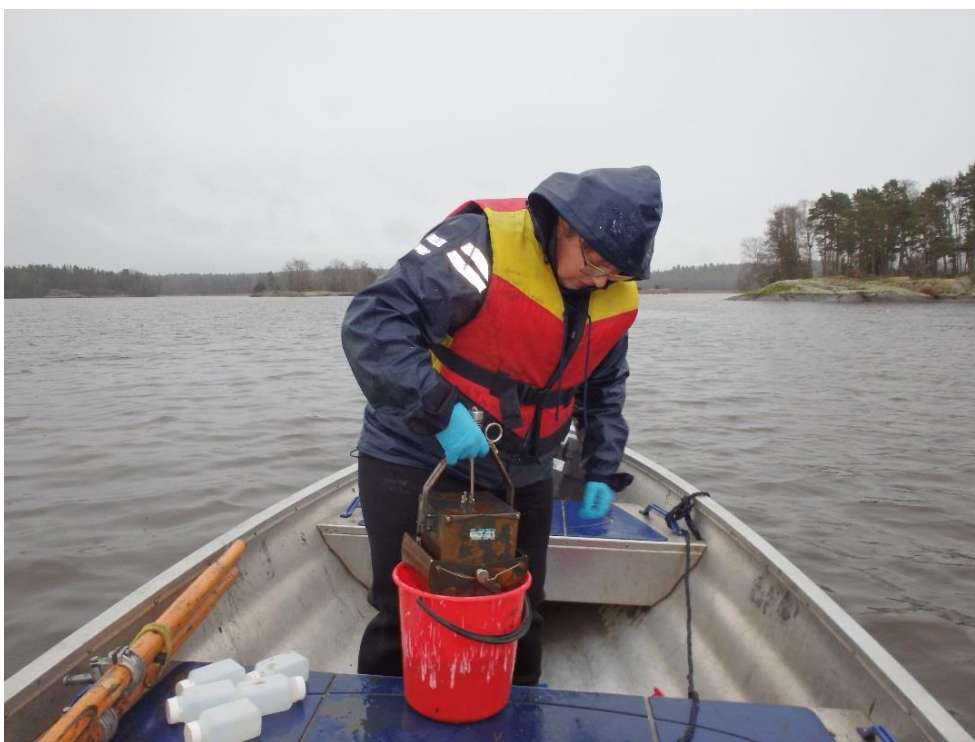
Figur 1. Provtagning med Ekmanhämtare (en typ av s.k. bottenhuggare).
