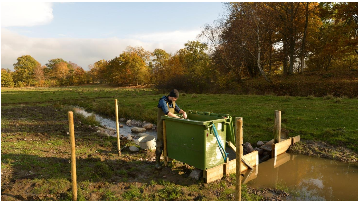
Figur 10. Emåförbundet etablerar en flödesstyrd provtagning vid en etablerad våtmark i Kalmar län 2016. Foto: P. Johansson
