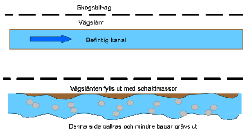
Figur 40. Skiss på åtgärdsförslaget vid Kanalen nedströms Mjölängarna, överst visas befintligt utseende och nederst framgår hur en försiktig omgrävning skapar ett mer naturligt lopp.
