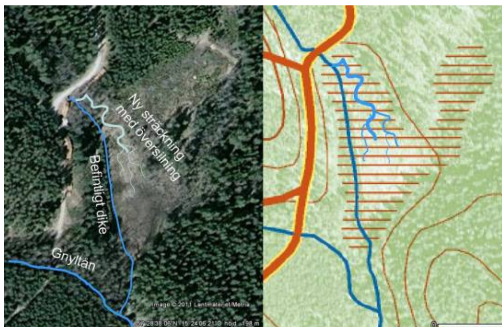
Figur 55. Idéskiss (satellitbild respektive kartbild) på hur befintligt dike genom den gamla kvarndammen vid Klackenhults nedre kvarn kan grävas om och översilas på befintlig mosse.
