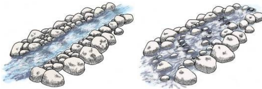
Figur 70. Skiss på genomförd biotopvård längs en rensad sträcka, till vänster före och till höger efter åtgärd. Ill. T. Nydén.
