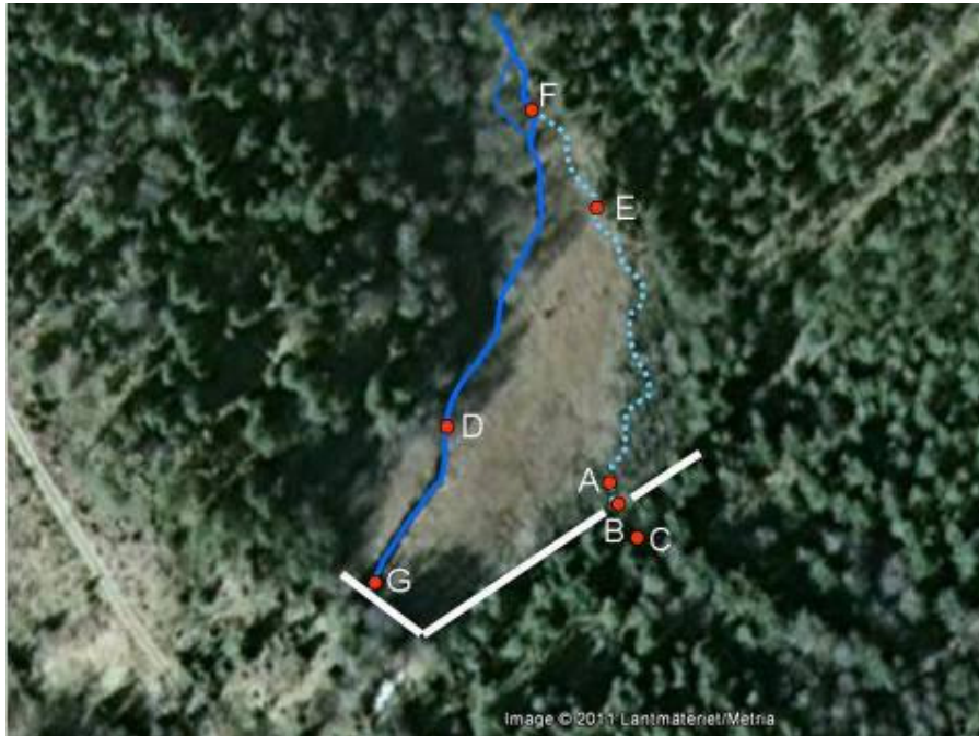
Figur 21. Inmätning vid Vedermödan med befintliga nivåer på nuvarande åfåra och det föreslagna omlöpet, se tabell 10 för nivåer.
