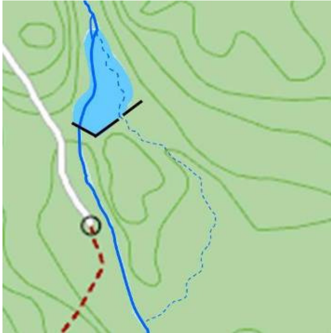
Figur 20. Skiss på ungefärlig sträckning av omlöpet vid Vedermödan, som börjar vid inloppet till dammen och rinner via gamla breddutskovet genom skogen väster om befintlig åfåra.
