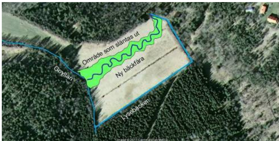
Figur 26. Skiss på ungefärlig utformning av ny bäckfåra i Lysebäck. Det gröna området visar ungefärlig utbredning på det område som sänks av och släntas ut för att skapa våtmarksområden och översilning.
