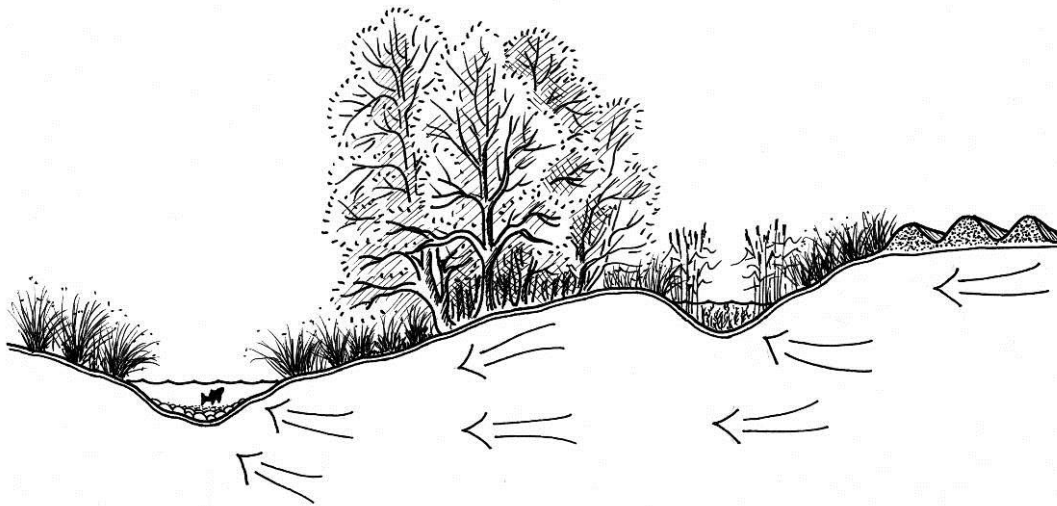
Figur 53. I det här exemplet på åplansrestaurering har en svacka grävts närmast åkerkanten till höger. Dessa svackor blir små våtmarker som kan ta hand om ytligt avrinnande vatten med höga kväve- och fosforhalter. Ill: T. Nydén.
