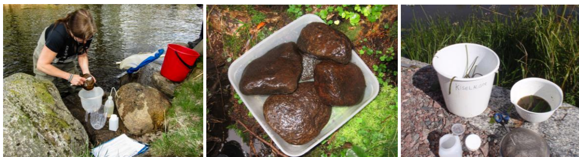
Figur 1. Provtagning av kiselalger görs i första hand på stenar som borstas med en ren tandborste. Påväxtmaterialet sköljs sedan ner i en behållare. Om inte stenar finns kan prov även tas från vattenväxter, © Medins Biologi AB.
