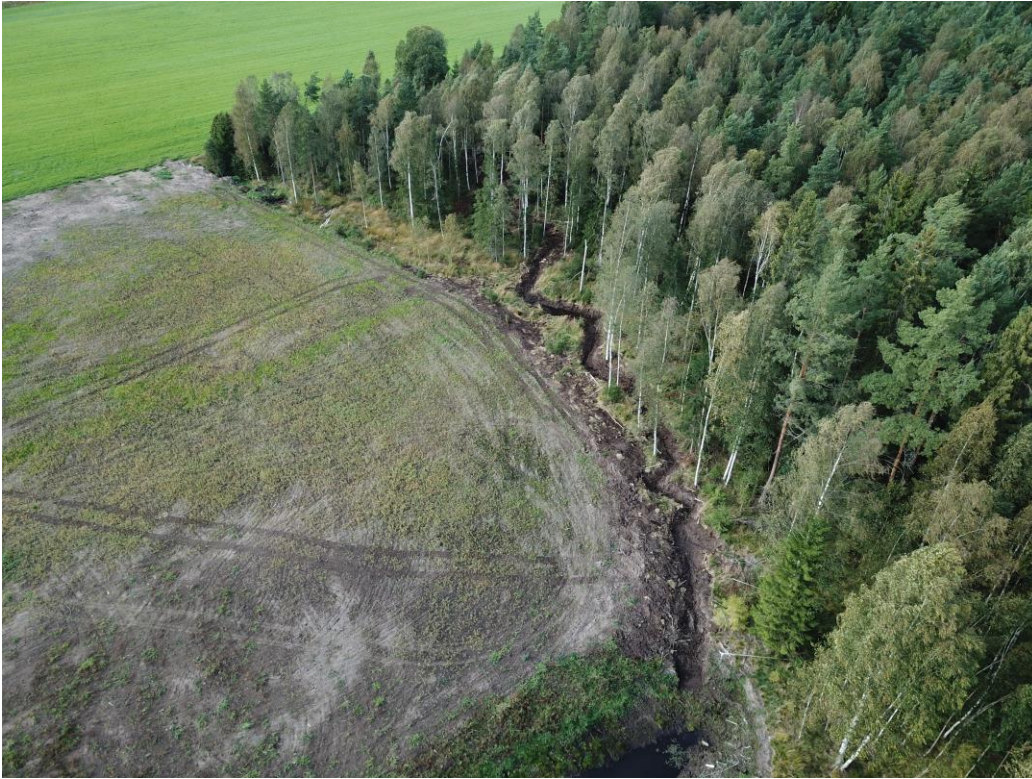
Figur 15. Nedre hälften av diketets nya, slingrande sträckning genom skogen ned till Bocksjön. Notera att mynningen längst ner på bilden ligger högre än rådande vattenyta i Bocksjön.
