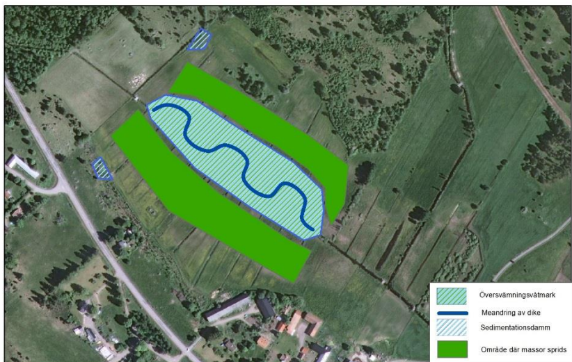
Meandring, översvämningsvåtmark & sedimentationsdammar på Tigerstad 1:5, Hultsfreds kommun
