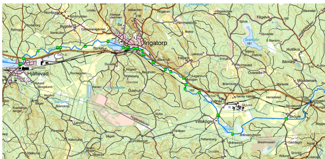
Figur 3-5. Del av Brusaån mellan Hjärtevad och Högebro med markering av punkter där tvärprofiler, brokulvertar och skibord har mätts in (gröna symboler).
