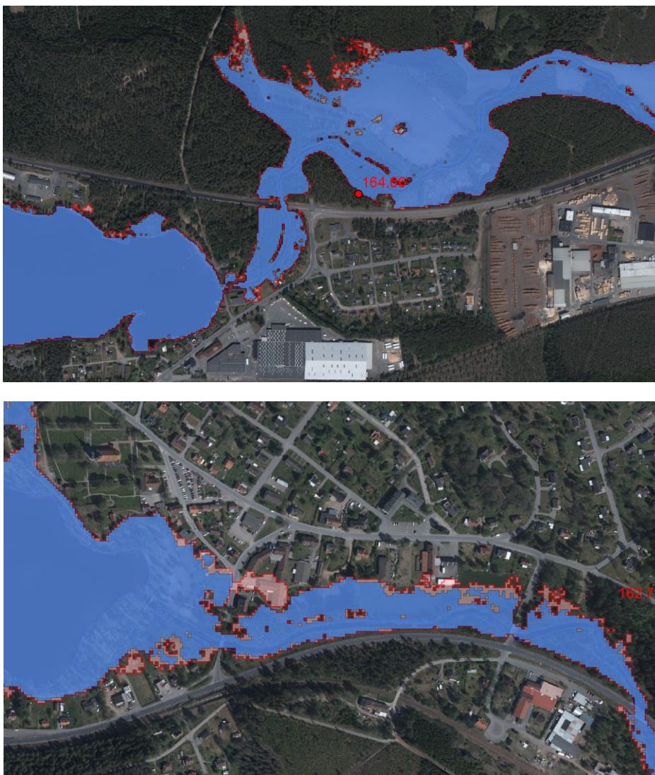
Figur 7-8. Nuläge. Maximal översvämningsutbredning i Hjaltevad (överst) och Ingatorp (underst) för 10-årsflödet (blått) och 30-årsflödet (rött).
