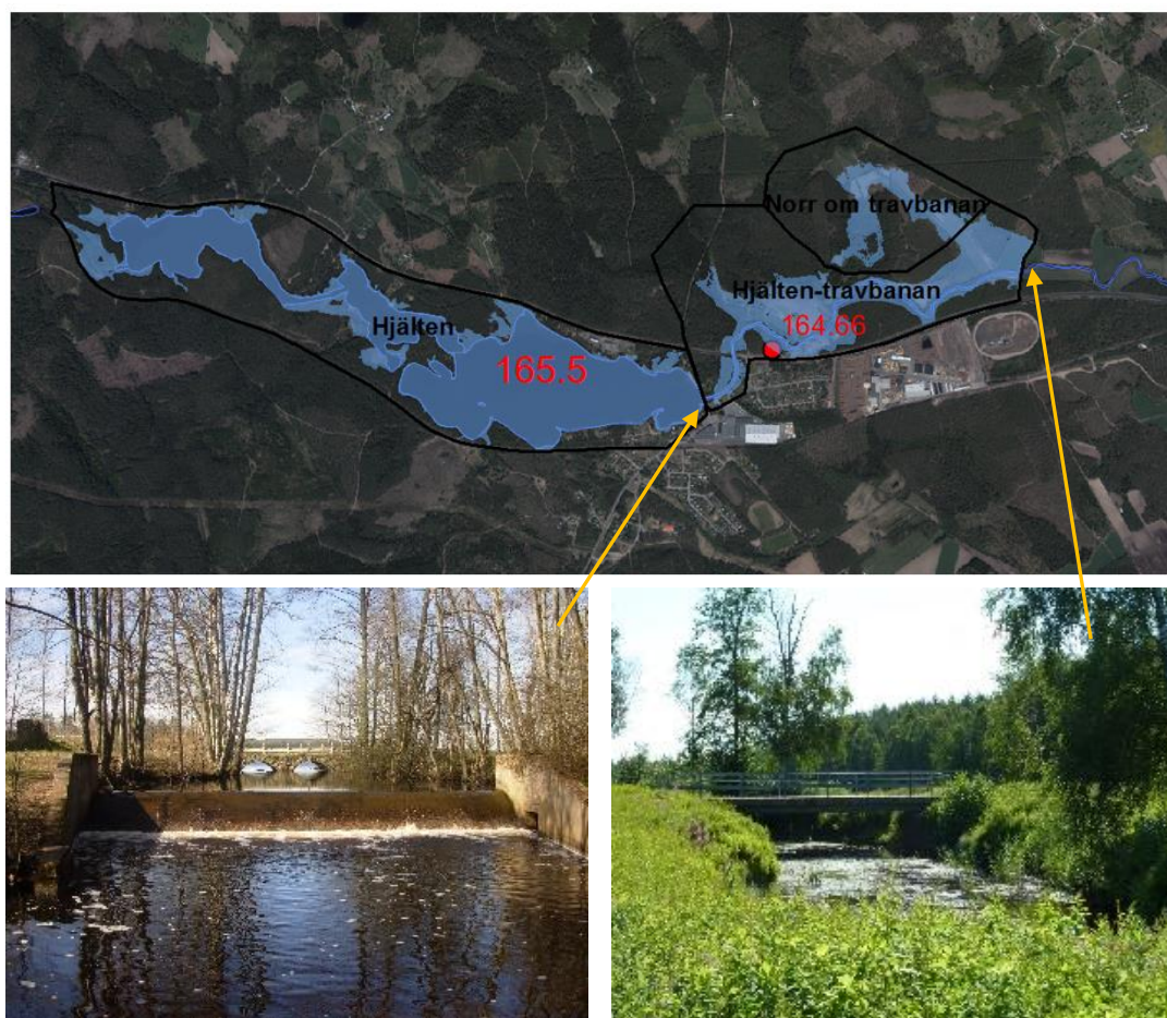
Figur 7-3. Markering av potentiella ytor för magasinering (överst), befintligt skibord vid Hjäldens utlopp (underst till vänster), befintlig bro i höjd med travbanan (underst till höger). Foto: Emåförbundet.
