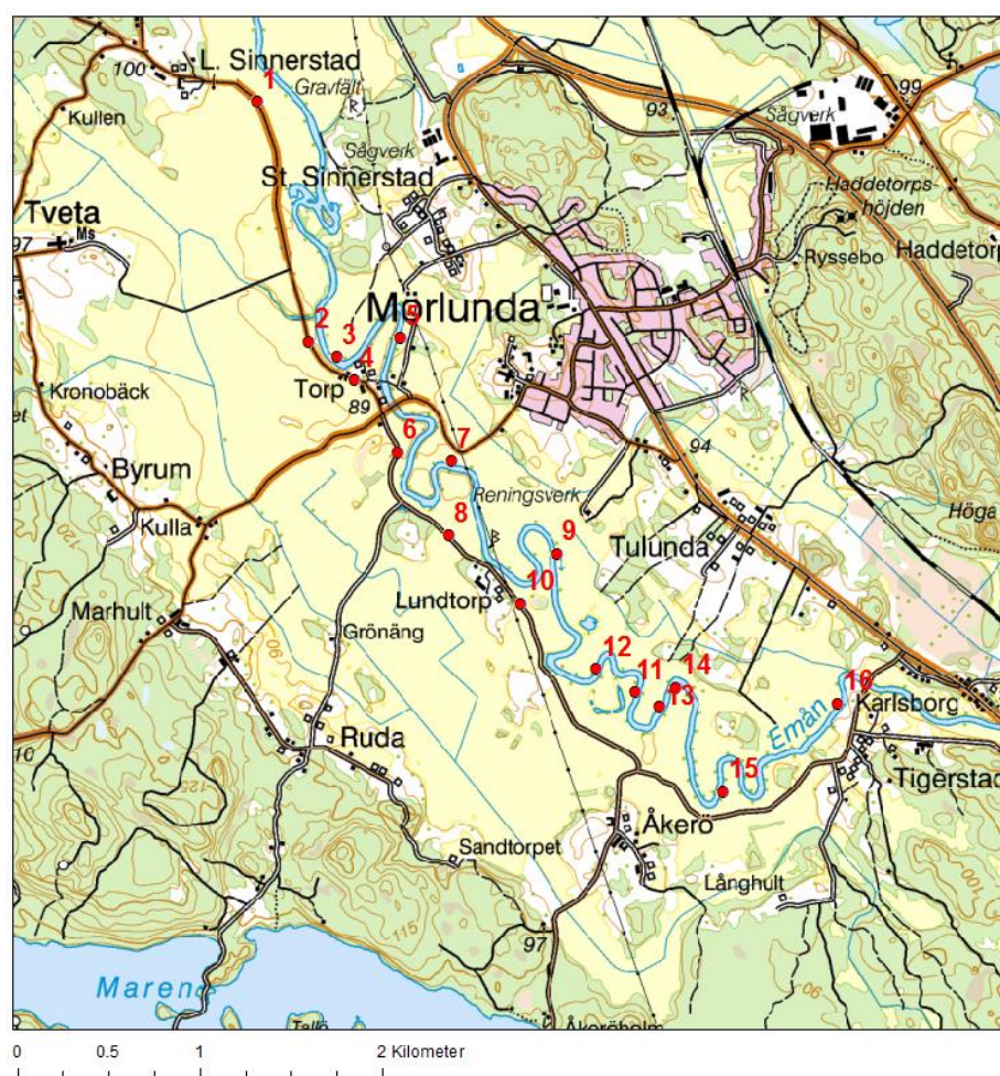
Figur 8-1. Markering av kritiska trösklar för översvämning från Emåns huvudfåra till dikessystemet öster och väster om Emån på sträckan mellan L. Sinnerstad och Tigerstad.
