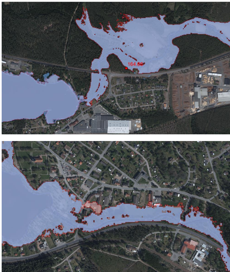
Figur 7-12. Åtgärd 1. Maximal översvämningsutbredning i Hjältevad (överst) och Ingatorp (underst) för 30-årsflödet före åtgärd (rosa) och efter åtgärd (ljusblått).
