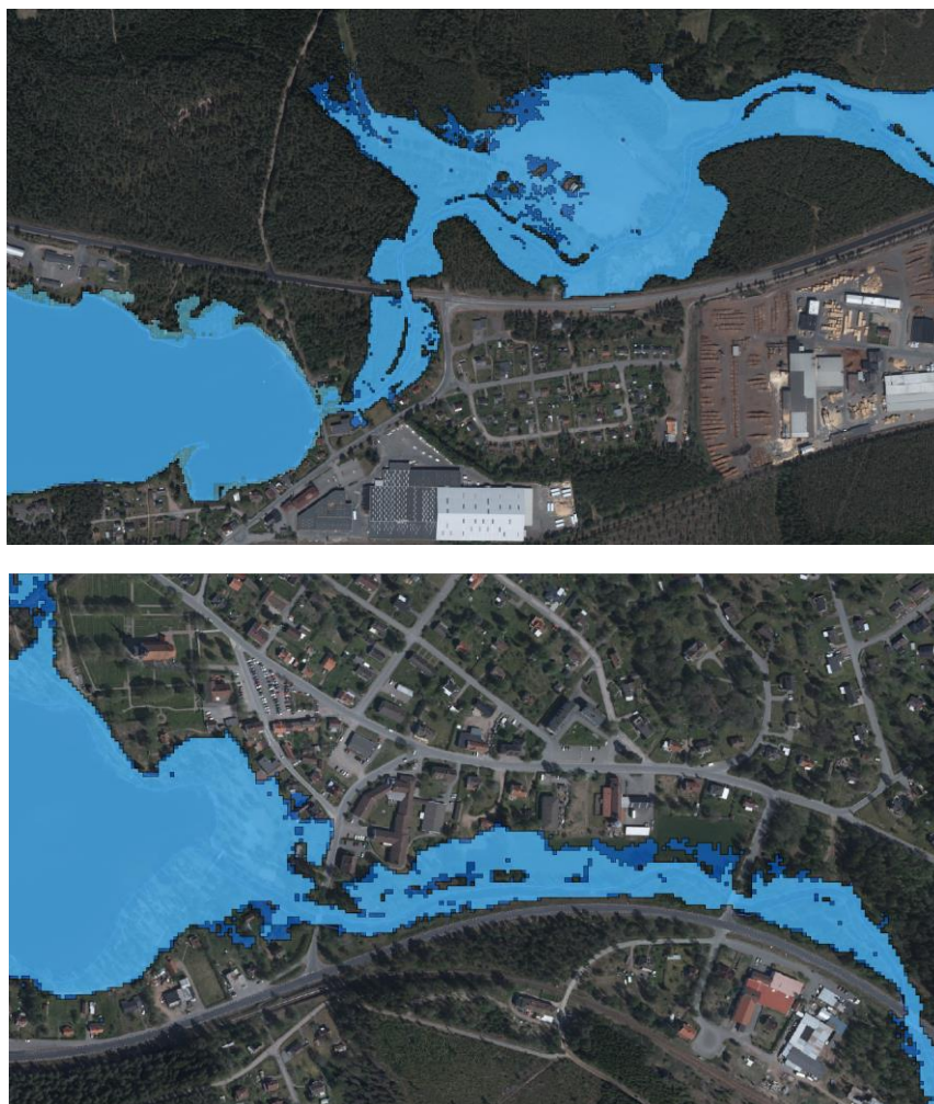
Figur 7-11. Åtgärd 1. Maximal översvämningsutbredning i Hjaltevad (överst) och Ingatorp (underst) för 10-årsflödet före åtgärd (mörkblått) och efter åtgärd (ljusblått).
