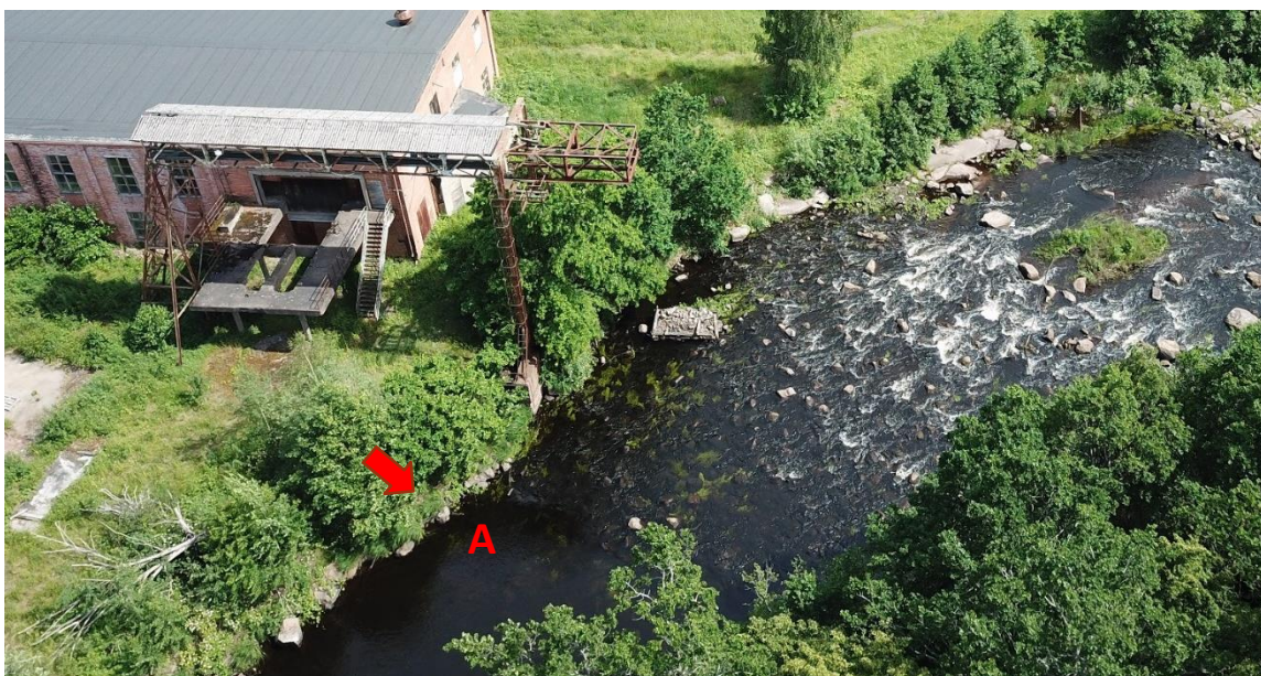
Figur 33. Åtgärdslokal 3F, omfattar strömsträckans övre del där en fin strömnacke finns vilket är en bra plats att sprida ut leksten och skapa ett större lekområde för laxfisk (A). Platsen är mycket lättåtkomlig från bruksområdet där en bandgående grävmaskin kan sprida ut materialet i området.
