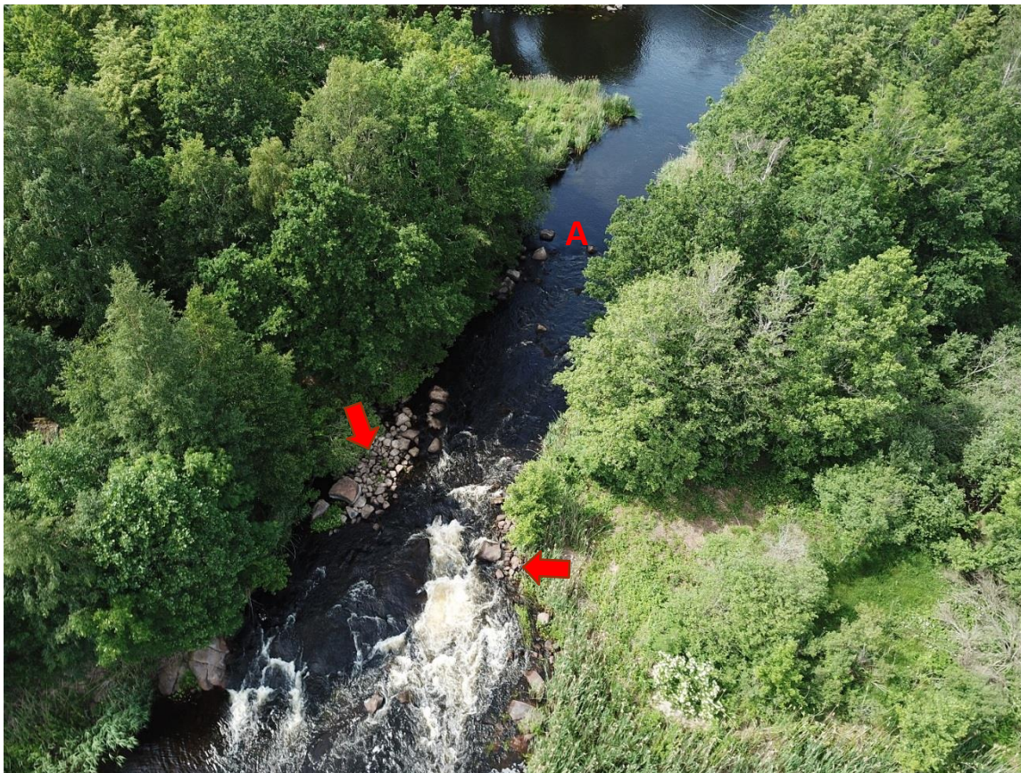
Figur 31. Den mindre av fårorna inom Emsfors gamla dämningsområde. Genom biotopvård kan en större lek- och uppväxtyta skapas. Befintligt uppensat stenmaterial (se pilar) sprids ut, framförallt längre uppströms men även nedanför fallet. Målet är att jämna ut nuvarande hårda fallprofil i den nedre delen så att strömhastigheten fördelas över en längre sträcka vilket ökar ytan uppväxtområden. Lekbotten etableras sedan i sträckans ovandel (A) med hjälp av helikopter i samband med övriga åtgärdslokaler där detta föreslås.
