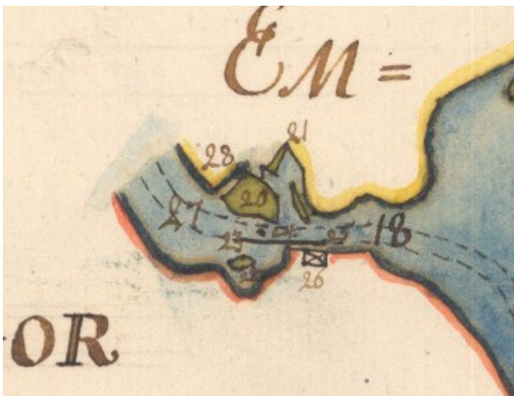
Figur 14. På en avmätningsskarta från 1784 finns bland annat platsen för Skruvhults pappersbruk markerad. Byggnaden på den södra stranden med nummer 26 visar på själva pappersbruket. Nummer 25 markerar platsen för en stenkista varpå hjulaxlarna låg. Stenkistan gick inte att identifiera vid den nu genomförda inventeringen.
