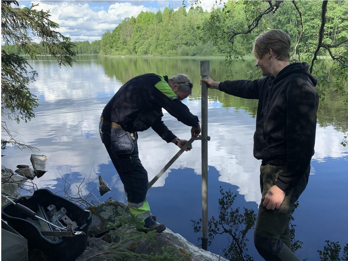
Figur 5. En nivågivare installeras i Nömmen försommaren 2020.
