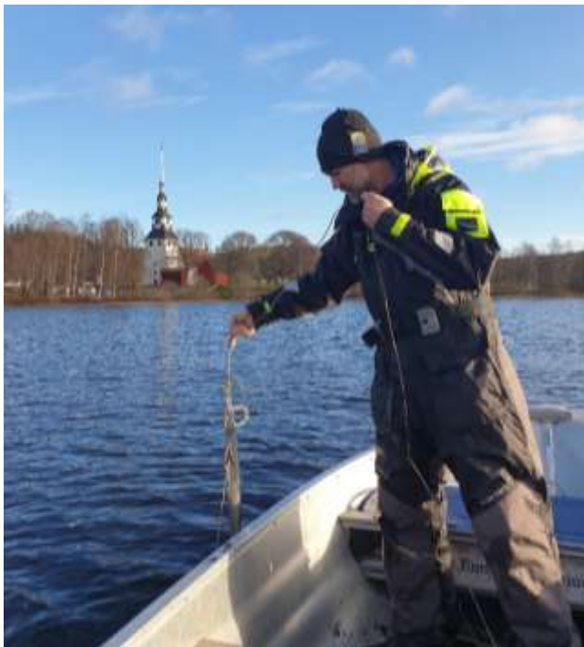
Figur 5. Sedimentprovtagning sker vart 6:e år inom SRK Emån (se tabell 2) och kan göras både från is och båt. Metodiken inom SRK Emån innebär att man tar flera prover inom den centrala djuphålan och tar vara på de översta 2 cm (ytsediment) i varje prov. Dessa samlas sedan i ett kärl och representerar ett s.k. samlingsprov som skickas in till laboratorium för analys enligt kontrollprogrammet
