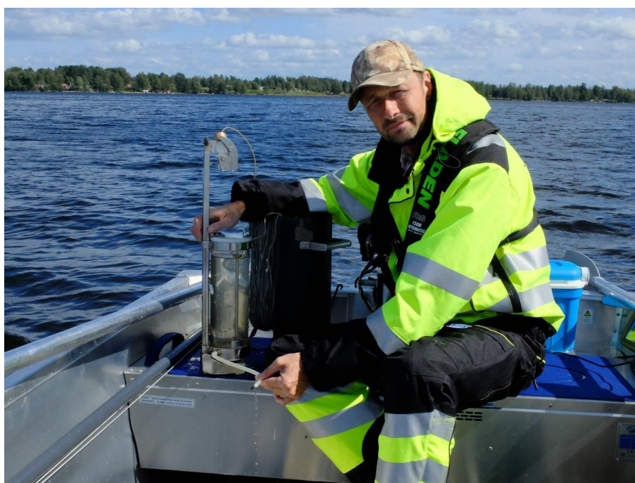
Figur 1. Ruttnerhämtnaren är ett nödvändigt och vanligt verktyg vid sjöprovtagning för att kunna ta prover på olika djup.
