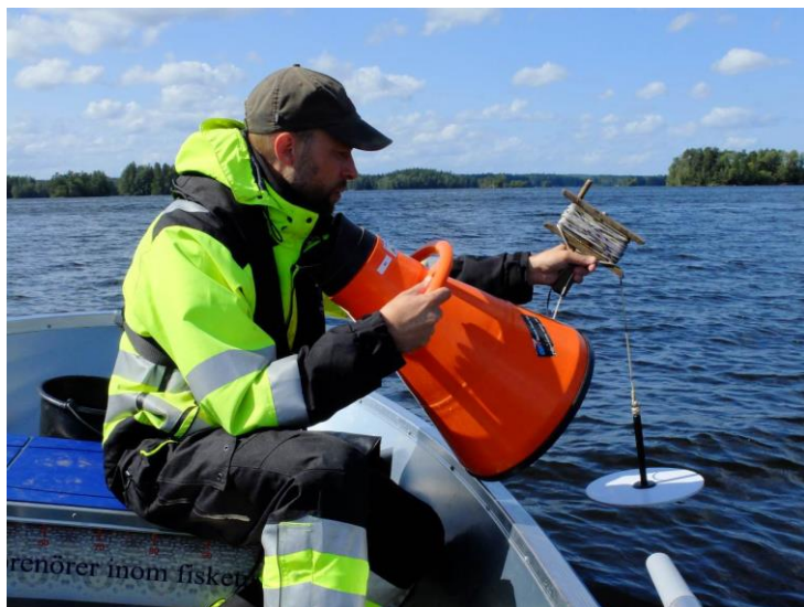
Figur 2. Att mäta siktdjup är en gammal metod för att bedöma ljusförhållanden i sjöar. För detta används en Secciskiva – en helt vit och rund skiva med en diameter på 25 cm. För att undvika påverkan från solreflexer och vågor, som lätt påverkar resultatet brukar man använda en vattenkikare vid mätningen.
