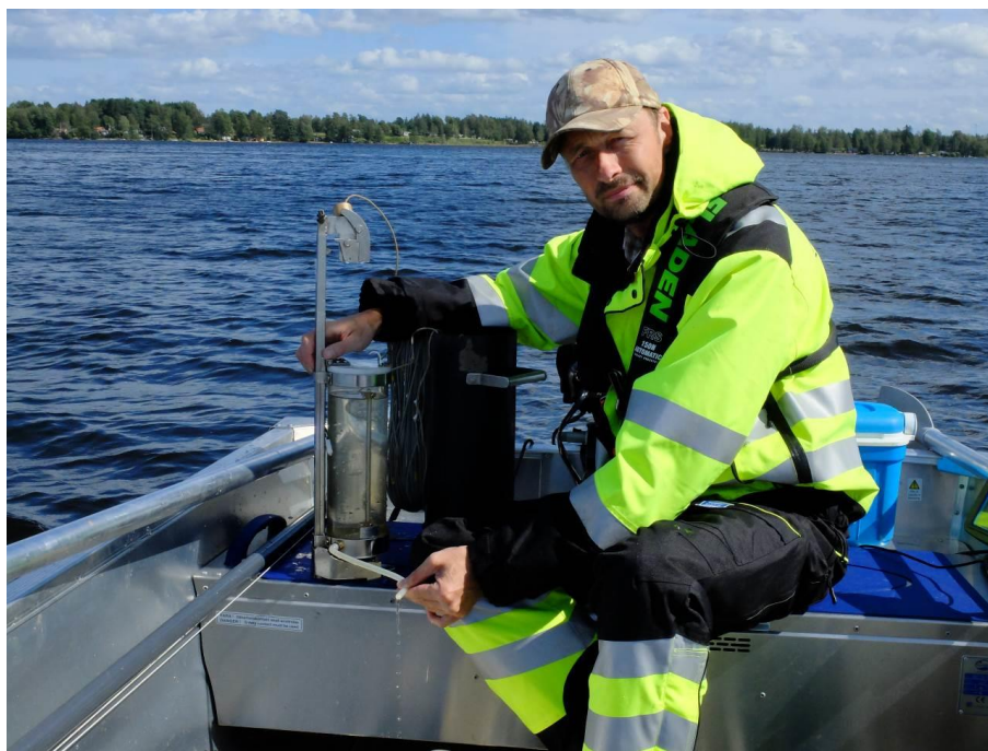
Figur 1. Ruttnerhämtaren är ett nödvändigt och vanligt verktyg vid sjöprovtagning för att kunna ta prover på olika djup.
