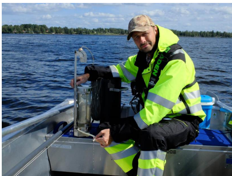
Figur 1. Ruttnerhämtaren är ett nödvändigt och vanligt verktyg vid sjöprovtagning för att kunna ta prover på olika djup.
