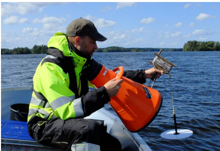
Figur 2. Att mäta siktdjup är en gammal metod för att bedöma ljusförhållanden i sjöar. För detta används en Secciskiva – en helt vit och rund skiva med en diameter på 25 cm. För att undvika påverkan från solreflexer och vågor, som lätt påverkar resultatet brukar man använda en vattenkikare vid mätningen.
