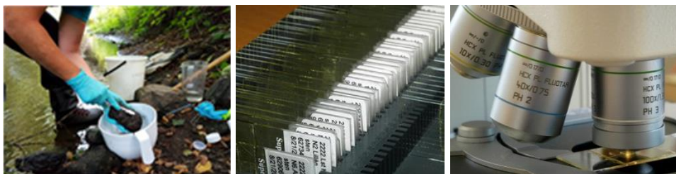
Figur 1. Provtagning av kiselalger görs i första hand genom att borsta stenar med en ren tandborste. Påväxtmaterialet sköljs sedan ner i en behållare och konserveras med etanol. Kiselalgsanalys görs i ljusmikroskop i 1000 gångers förstoring med oljeimmersionsobjektiv. Mikroskopet ska helst vara utrustat med interferenskontrast, vilket gör att man kan se mycket små former tydligare än med andra tekniker.
