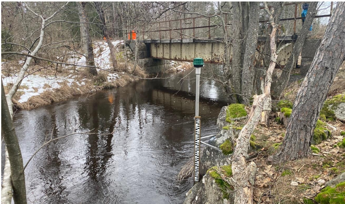
Figur 21. Vid en av peglarna längs Fliserydskvillen finns en ny mätstation installerad sedan hösten 2020. Stationen mäter flöde och vattentemperatur och data visas via www.emån.se . Foto: J. Nilsson.
