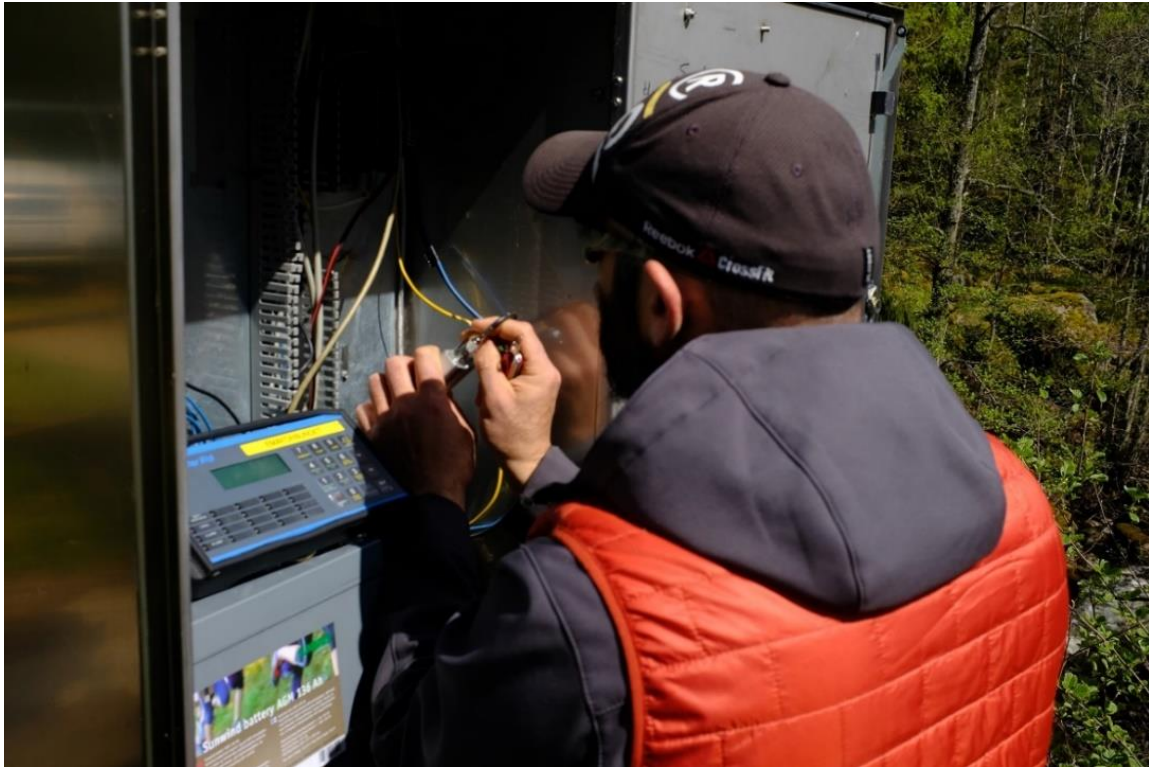
Figur 14. Emåns nivå- och flödesmätningssystem kräver tillsyn och skötsel. Här ser Ilan Leshem till så att stationen vid sjön Salen åter börjar leverera data till servern våren 2020. Foto: P. Johansson.
