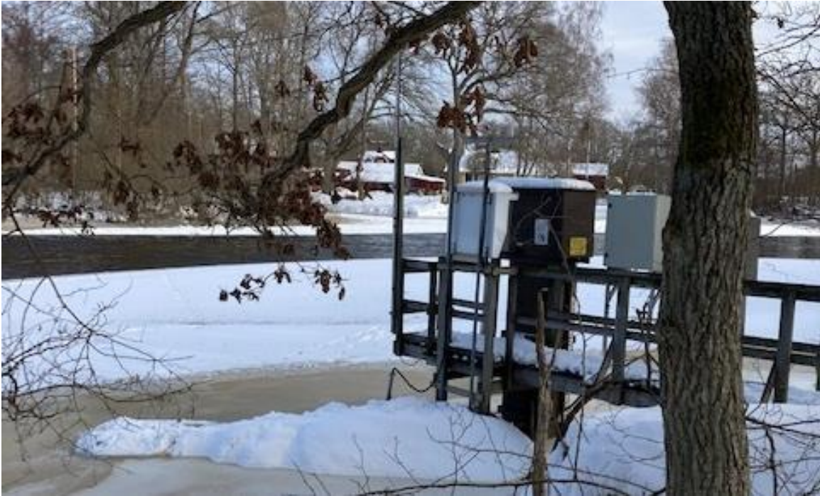
Figur 15. Under en kall period i februari 2021 frös delar av vattendragen. När sektionen blir smalare stiger vattennivån och mätstationen registrerar ett högre flöde, eftersom flödesmätning bygger på ett nivå-/ flödessamband. En flödeskorrigering måste göras i efterhand. På bilden SMHI:s mätstation vid Emsfors. Foto: I. Leshem.
