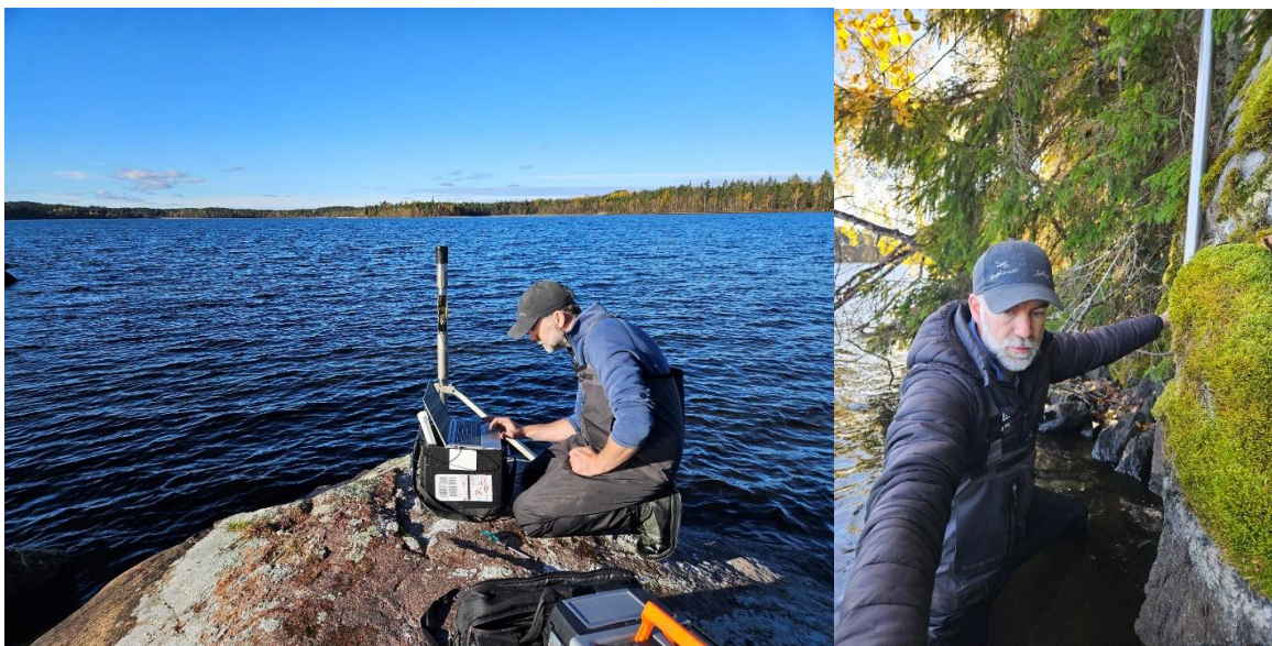
Figur 16. Etablering av nivåmätningsstationer i Fagerhultasjön och Byasjön inom Emåns avrinningsområde. Foto: P. Johansson.
